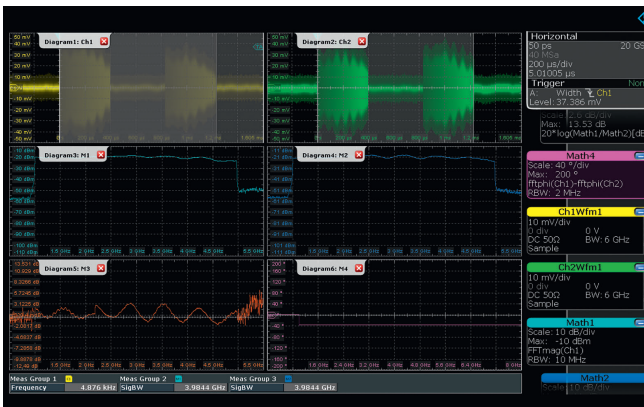
Bild 3: Transientanalyse eines Chirp-Sequence-Signals mit der VSE-Softwareoption Transientanalyse R&S VSE-K60c. Links oben ist die Leistung der Pulse als Funktion der Zeit dargestellt. Die lineare Frequenzmodulation ist in der Mitte oben sowie im Spektrogramm (links unten) zu sehen. Die Software listet die Eigenschaften detektierter Pulse tabellarisch auf (unten Mitte), sie können auch grafisch detailliert untersucht werden, wie die Chirp-Rate sowie Abweichungen der Frequenz (rechts). © Rohde & Schwarz
